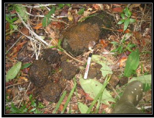
Foto 4. Bongkahan bijih besi berupa hematit/ goetit pada zona lateritik , kadar Fe total : 49,45%
