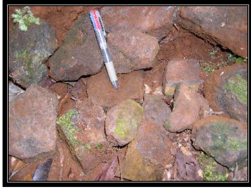
Foto 2. Bongkahan bijih besi pada zona lateritik di daerah Bukit Belah; berupa hematit, mengandung Fe total : 54,89%.
